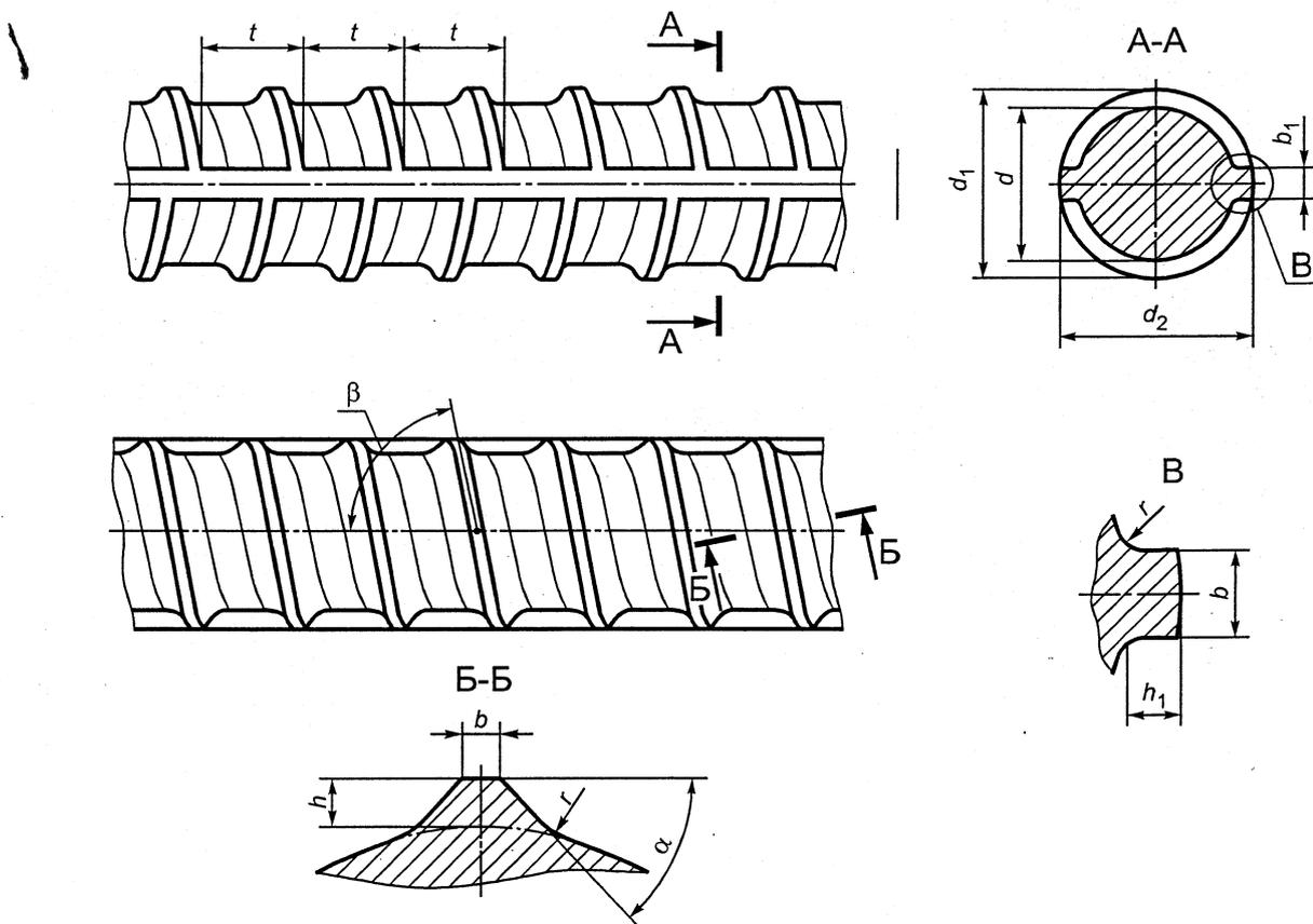
Рисунок 1 — Конфигурация и параметры периодического профиля по форме 1ф
