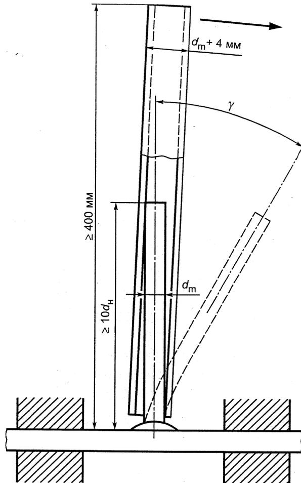
$d_m$  — максимальный номинальный диаметр поперечного сечения испытуемого проката
